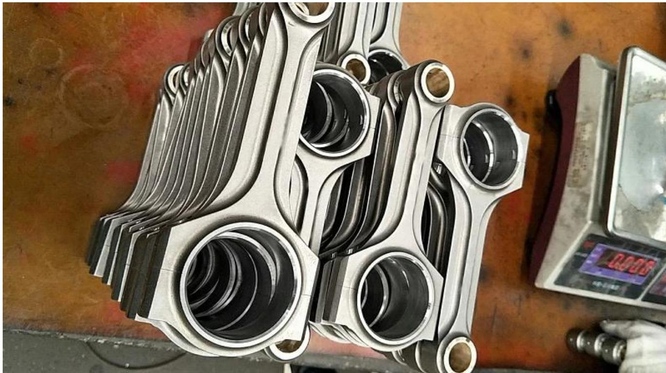
Conjunto de varillas de conexión Nissan 350Z Infiniti G35 3.5L V6 VQ35DE son para uso en aplicaciones que requieren un enlace reforzado entre el cigüeñal y el pistón. Barras de conexión X Viga para Nissan VQ35DE 350Z G35 VQ35 son muy superiores a cualquier varilla fabricada OEM y pueden contener 1000 caballos de fuerza.
