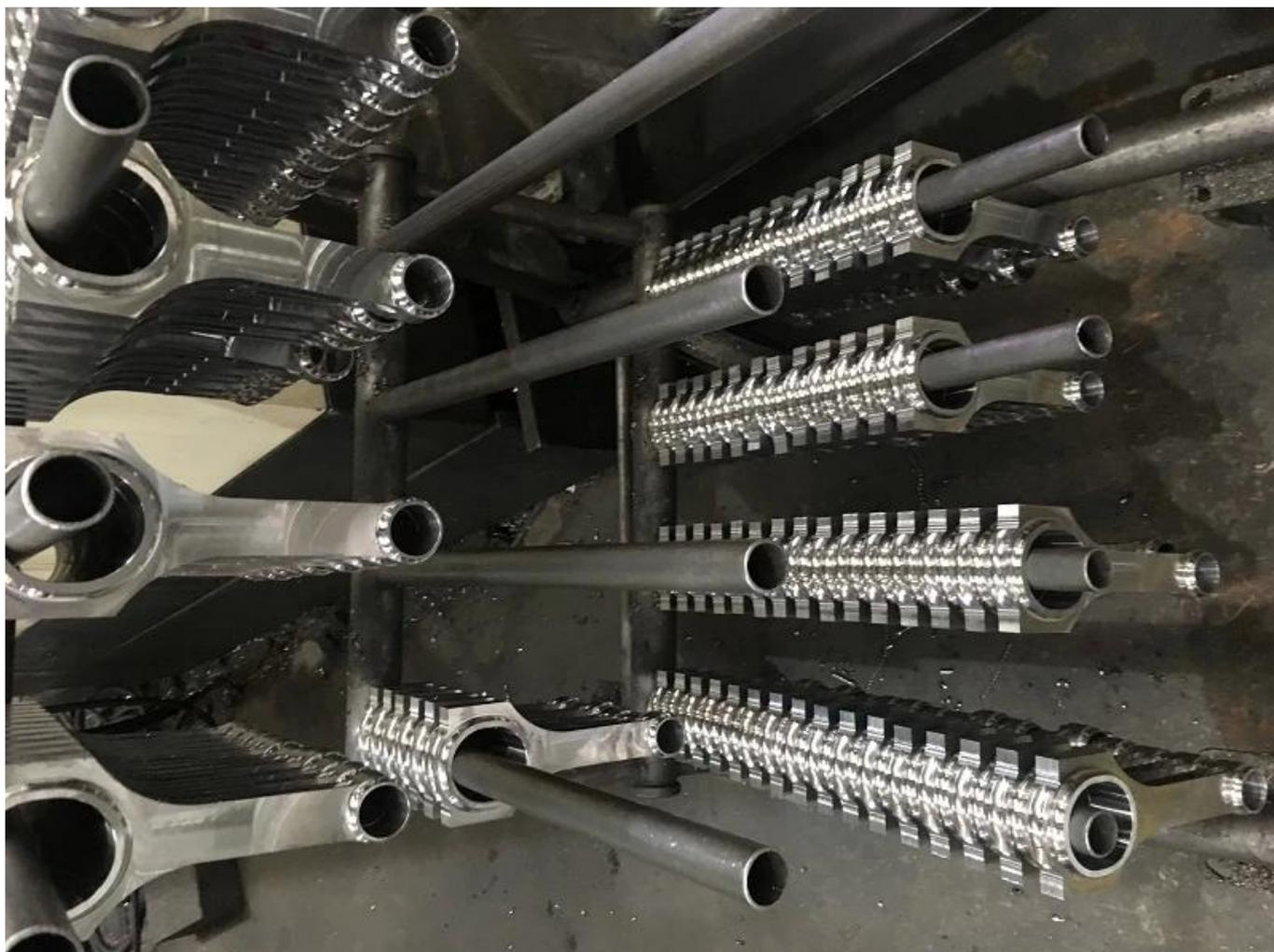
Bielas forjadas para Honda Civic CRX D16 D16A D16Y7 D16Y8 D16Z6 ZC se mecanizan a partir de forja de una pieza. Después de terminar la parte de la superficie y la viga de mecanizado, las bielas Honda D16Z6 / D16Y7 1.6Ltr 16V serán pulidas y pulidas para una vida útil mejorada.
