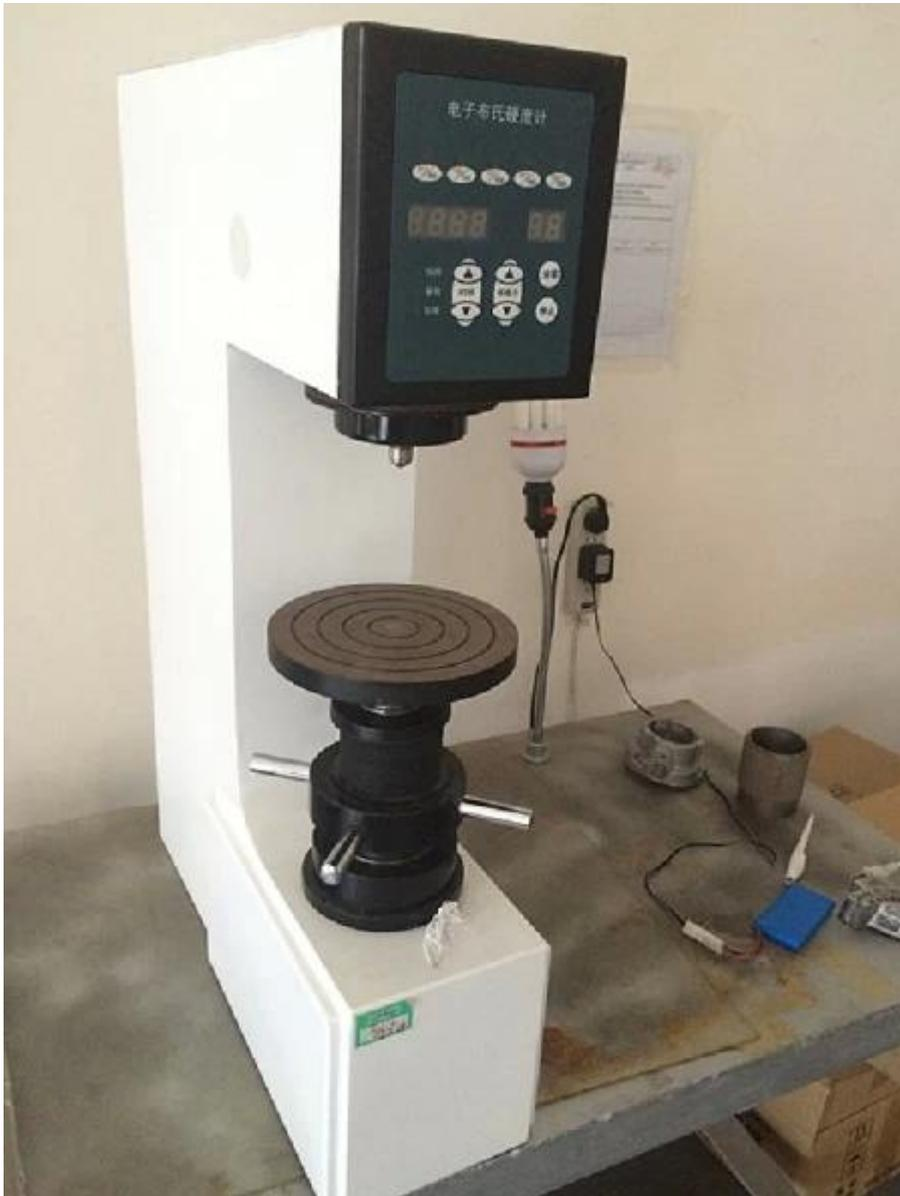
Nota: esta es nuestra máquina de prueba de dureza, el huracán bielas dureza 34-38 HRC.
