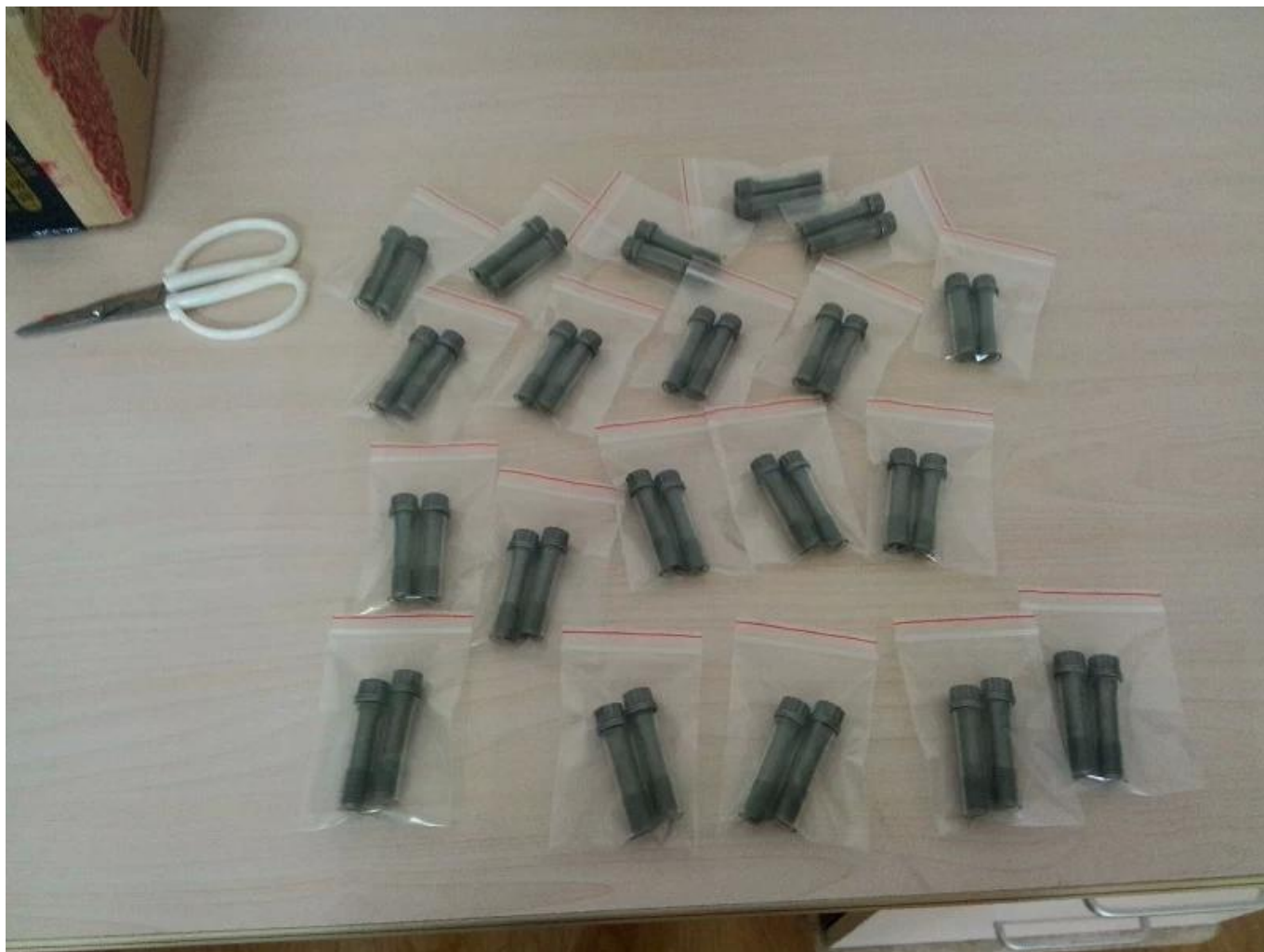
Pernos de bielas de huracán de tamaño 3/8 con 1.600 pulgadas de longitud de cabeza (UHL)
