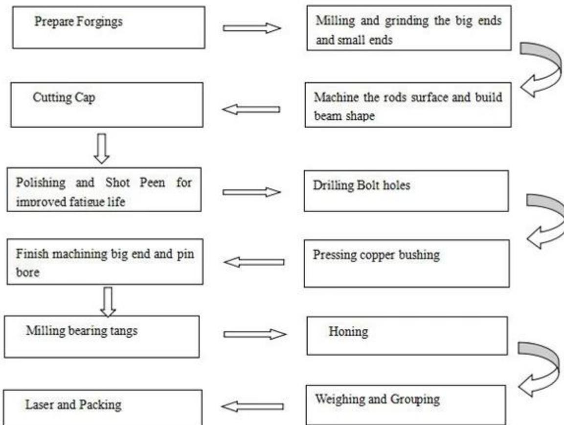
Hurricane puede producir bielas de acuerdo con la muestra usada y especificaciones detalladas, si nosotros diseñamos su estilo de bielas, aquí hay algunos pasos para su referencia como se muestra a continuación:
