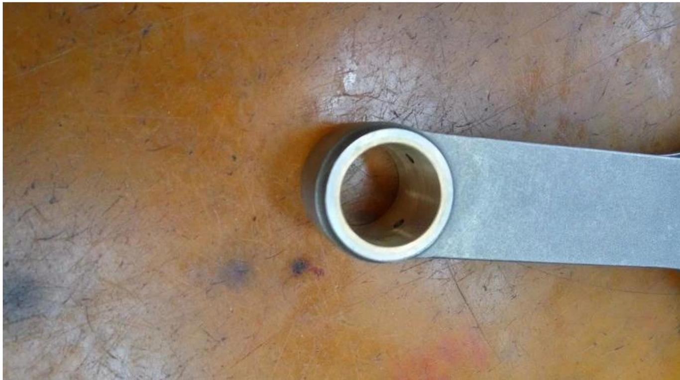
Nota: Bielas de viga Toyota 2jzgte h Orificio de aceite en el extremo del pasador que proporciona lubricación.
