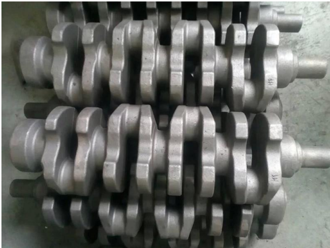
Cigüeñal remanufacturado para forjas Ford 302: Sello múltiple forjado a partir de 4340 Chromoly (uno de los materiales más fuertes disponibles para cigüeñales)
