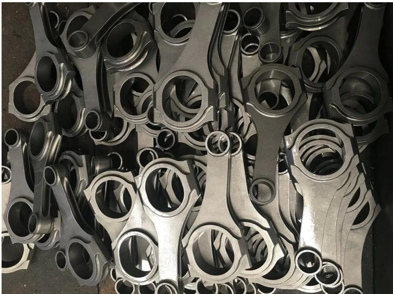
Presentando una nueva biela de perfil Pro H para el motor Subaru BRZ / Scion FR-S FA 20. Micro Pulido mejora la durabilidad de las varillas mientras deja un acabado de gran apariencia y Shot Peening la superficie de las bielas puede aliviar el estrés, mejorar la vida de fatiga. Para obtener más información, consulte nuestra página de noticias: [Bielas Shot Peening y Mirco-Polishing, aspecto especial A-level](#)
