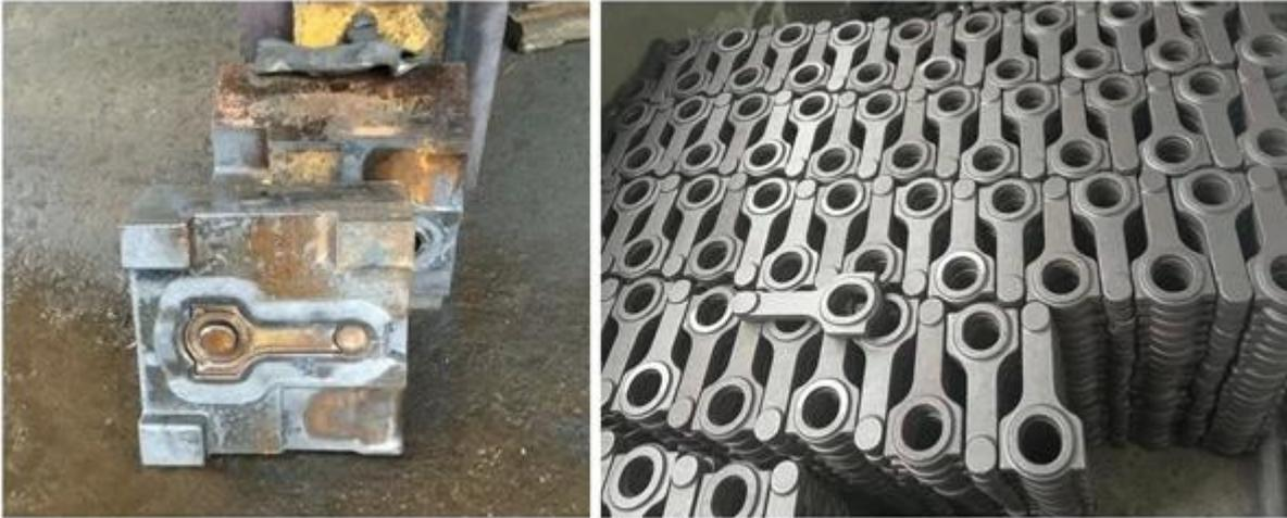
Luego, varillas de la máquina en el equipo desde una forja hasta semiacabado hasta varillas finales
