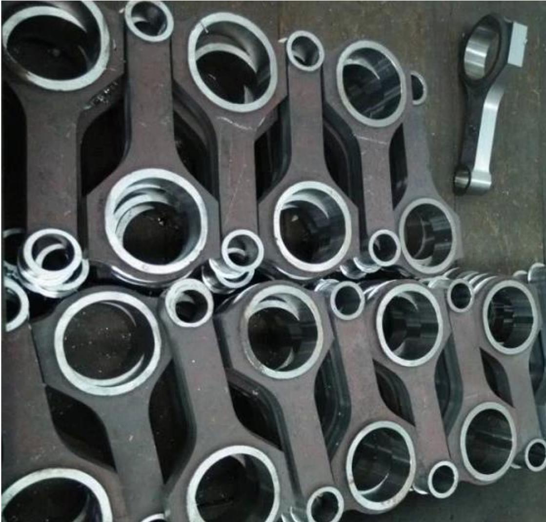
**Nota: Este es un progreso de perforar Varillas de conexión de acero forjado de repuesto para motores Buick Agujero de extremos grandes y pequeños, que actúa como un localizador confiable en todo el proceso.**
