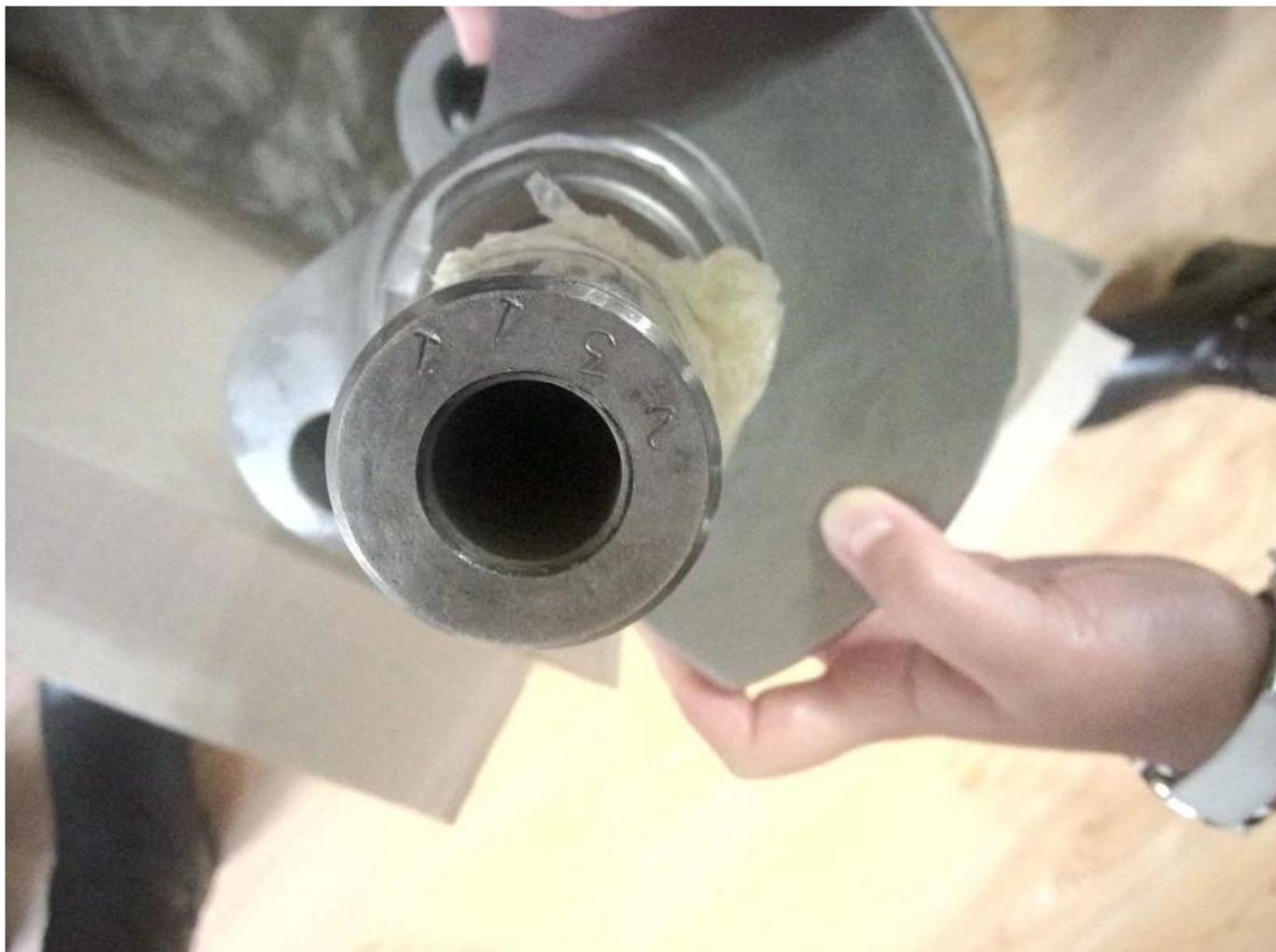
Hurricane finished LS1 Forged 4340 Steel Crankshaft 3.900 "Stroke también se muele a tamaños EXACT, magnafluxed y dinámicamente balanceados. Mucho más cada pieza de nuestras bielas LS1 tiene número de serie (marca de identificación).
