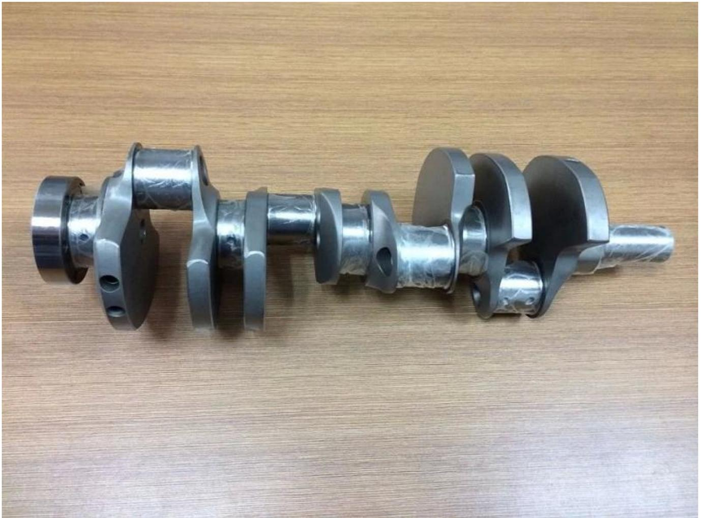
Este es nuestro Chevy LS1 Forged Crank 3.900 "Stroke, está diseñado para aplicaciones de rendimiento para aplicaciones fuera de carretera, calles y carreras. Todas las manivelas forjadas GM LS1 4340 son mecanizadas por CNC a partir de una pieza de acero cromado forjado, y están pulidas y micro pulidas. Nitrurado La nitruración es un proceso costoso en el que el cigüeñal está expuesto al gas en condiciones de calor y presión, esto crea un diario muy duro y fortaleza agregada
