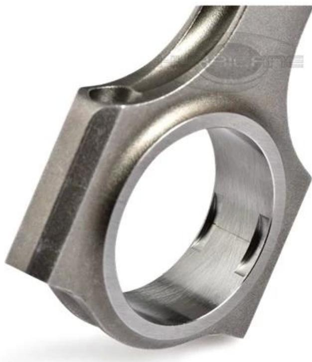
Nota: Huracán H haz Honda B16 conrods con 3 X 45 ° diseño de hombro, cuatro etiquetas de rodamiento.
