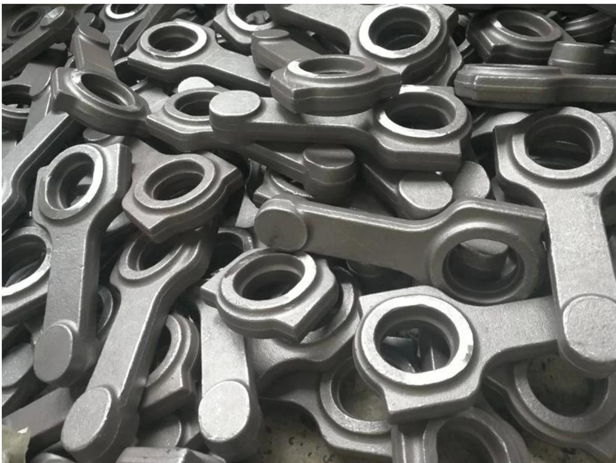
Nota: forja de una pieza, HRC: 34-38. El material se maneja con pinzas y se coloca en cada una de las impresiones de biela talladas en un bloque de matriz. A medida que el martillo corre el martillo, desplaza el metal suave y blanco caliente en cada impresión, formando gradualmente la biela. El martillo, que impone una fuerza de 3.000 libras, impacta el material un golpe por segundo. Tres golpes del martillo y la biela están forjados.
