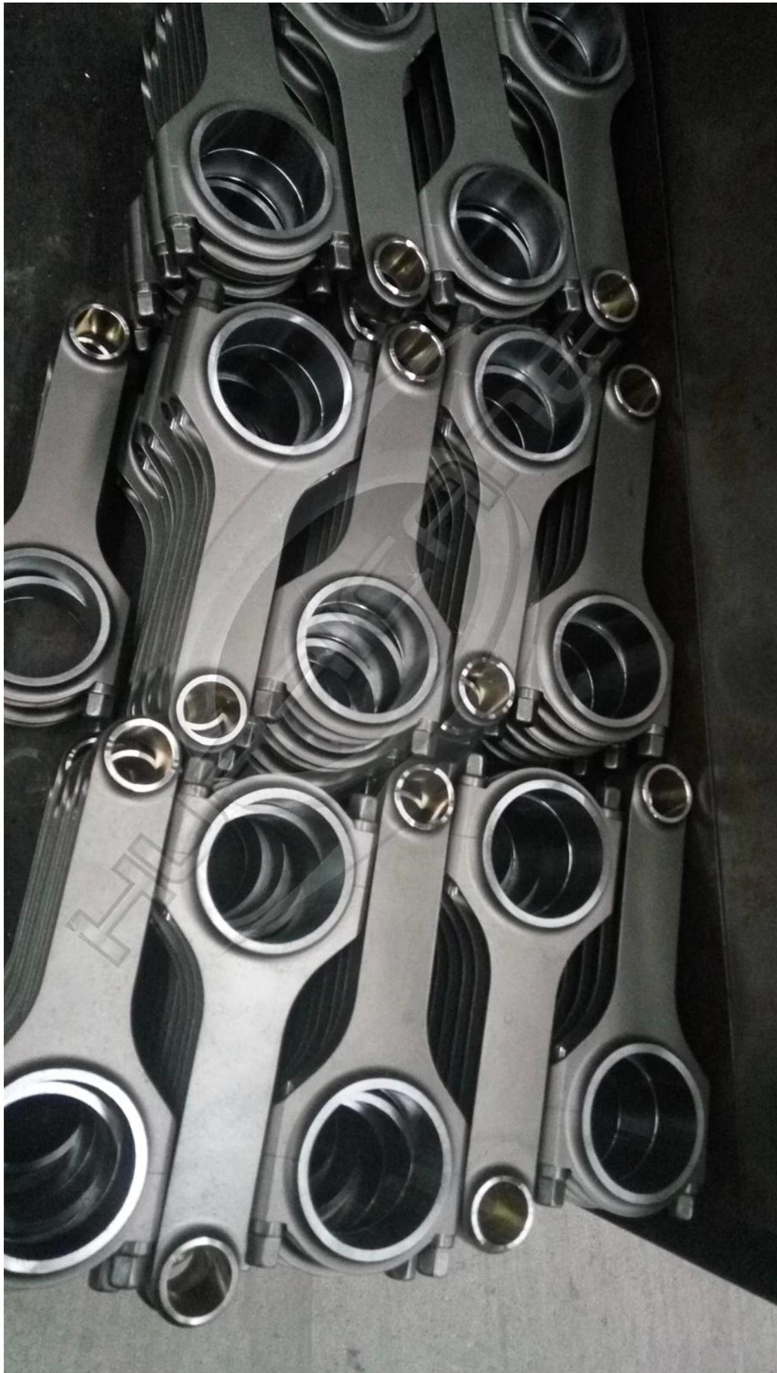
Todas las varillas se empaquetaron bien en la fábrica de Hurricane antes del envío, aquí una imagen del embalaje de las barras en V de Opel c20xe para su referencia, como se muestra a continuación:
