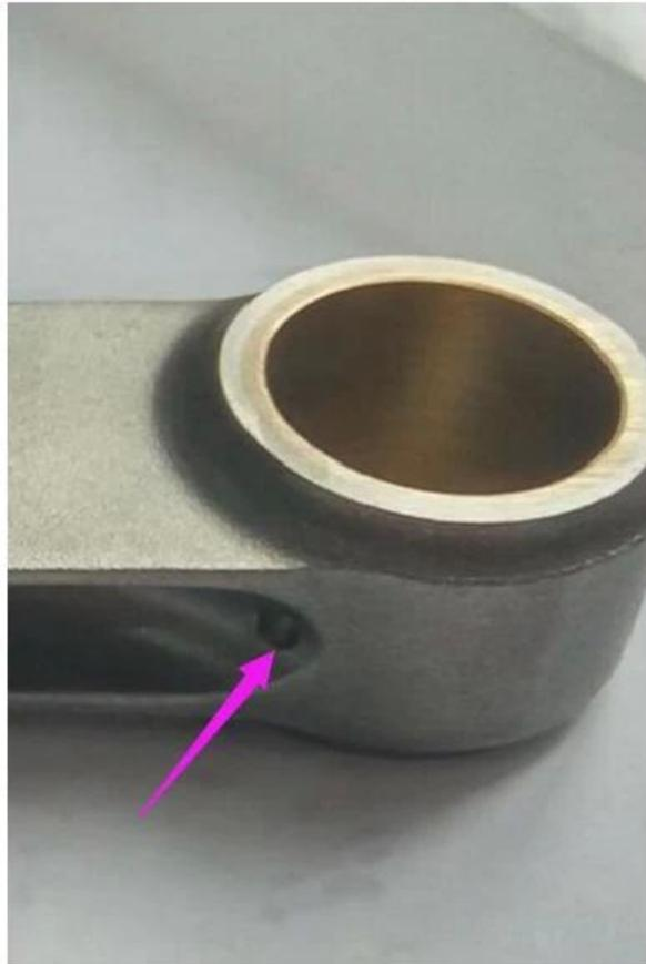
Dos pequeños orificios de aceite perforados en la viga del extremo pequeño cortados para una buena lubricación.
