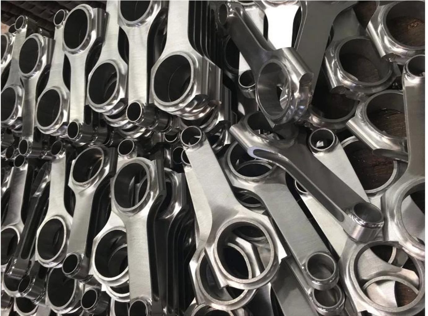
Nota: la biela H-Beam para la máquina de pulido BMW E30 M3 S14 avanza en la fábrica de huracanes.
