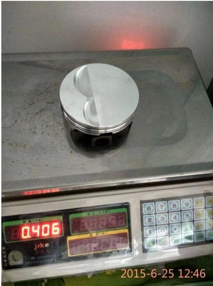
Nota: construcción de alta resistencia, pero tiene un peso ligero de 406 g por pieza.
