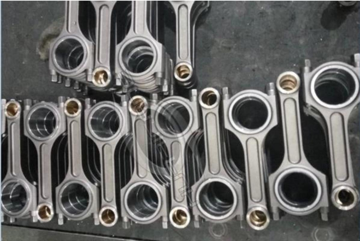
3) Tratamiento térmico a HRC 34-38 y pulido y finalmente pelado para una alta resistencia a la fatiga.
