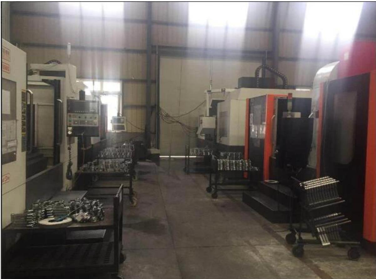
Estos molinos de la máquina, muelen y perforan en la biela. La mayoría de las fábricas usadas para trabajar a máquina con el trabajador, que era un proceso que consumía tiempo. Para reducir el tiempo y mejorar la calidad de las barras, actualmente todas las barras trabajadas a máquina con la máquina completa del
