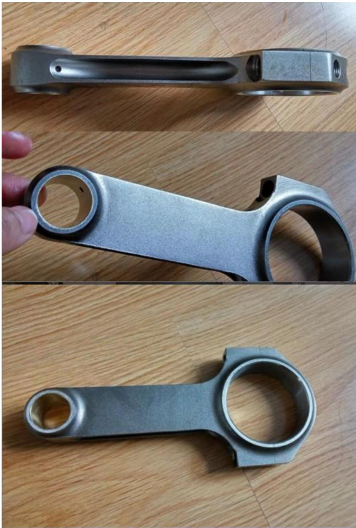
En el presente, [5.394 "](#), [5.400 "](#), [5.500 "](#), [5.600 "](#) y [5.700 "](#) Se pueden proporcionar barras para usted. **¿Varillas cortas o largas?** La elección es suya, pero los fabricantes de motores modernos saben que las barras más largas producen más potencia al reducir la carga lateral en los pistones. Las barras largas
