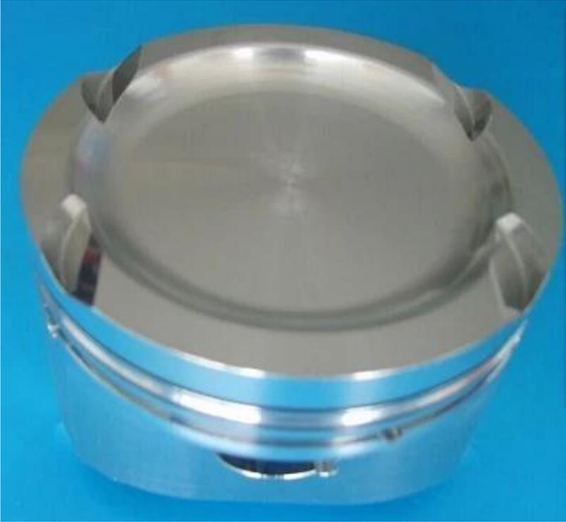
Nota: Normalmente, los pistones de plato se utilizan en aplicaciones reforzadas que no requieren un árbol de levas de alta elevación o una relación de compresión alta.
