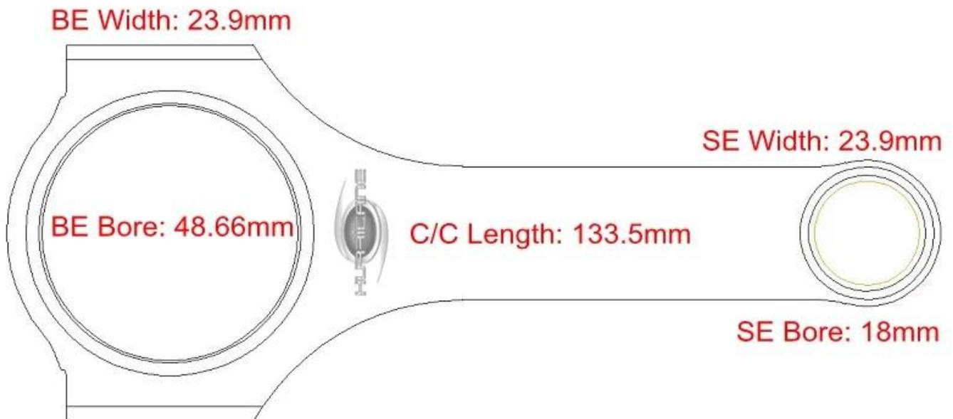
Citroen / Peugeot 106 GTi / S16 1.6L TU5J4 133.5mm La biela en H se fabrica con acero 4340 de alta resistencia a la tracción y está diseñada para un alto rendimiento y una durabilidad extrema. Se someten a granallado para aliviar el estrés del material y se tratan térmicamente en varias etapas para aumentar la rigidez. Las estrictas tolerancias en el proceso de producción aseguran un ajuste perfecto al tiempo que optimizan las holguras de aceite. Doblar y torcer está firmemente controlado.
