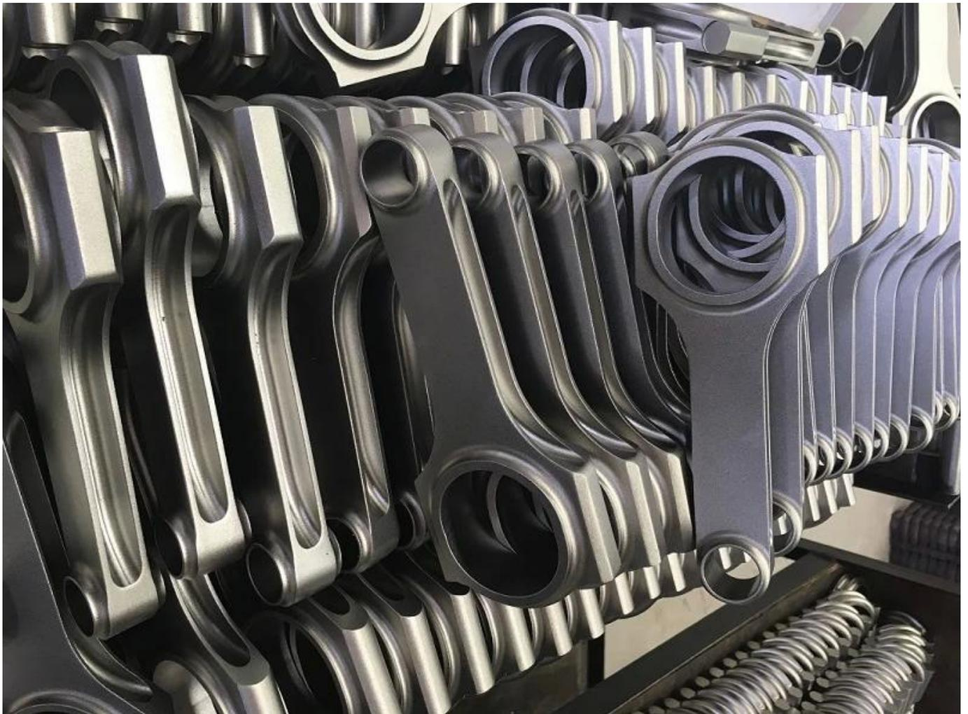
Nota: Las rebabas, el pulido (eliminar las rebabas y suavizar la superficie) y el granallado (la bola pequeña golpea la superficie y la hace en la superficie, aumenta la resistencia de las barras con la bola pequeña) son operaciones cruciales en la fabricación de una biela de competición.
