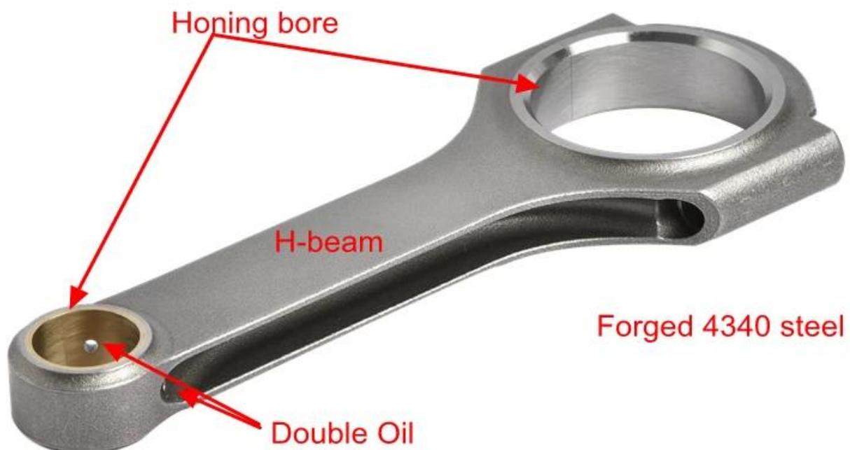
Según la tapa y la viga de la varilla toyota 22RE conectadas por tacos de acero de alta calidad, material: 40Cr, HRC: 38-40.
