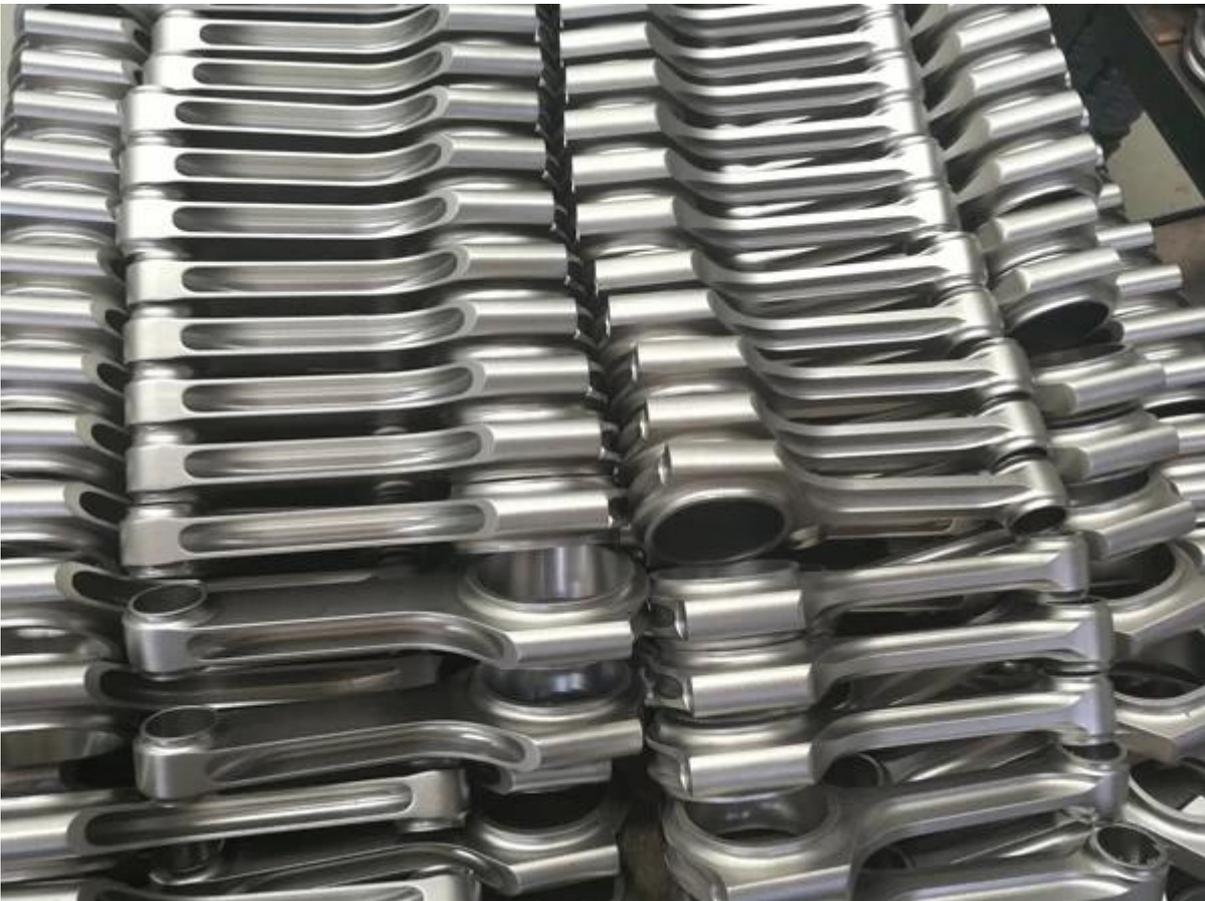
Se insertan bujes de bronce de silicio para un pasador de pistón flotante.
