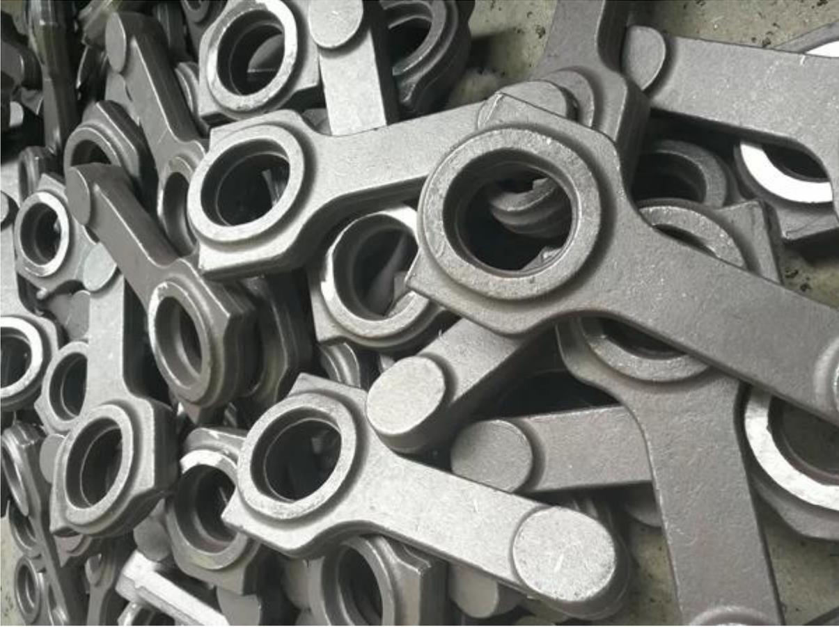
Cada vara es disparada. En g Para aliviar el estrés del metal. rayos X, medida, y Magna-fluxes cada barra para asegurar la calidad. Cada varilla es tratada térmicamente en varias etapas. Y si es necesario, se puede instalar y proporcionar un tornillo Hurricane 7/16.
