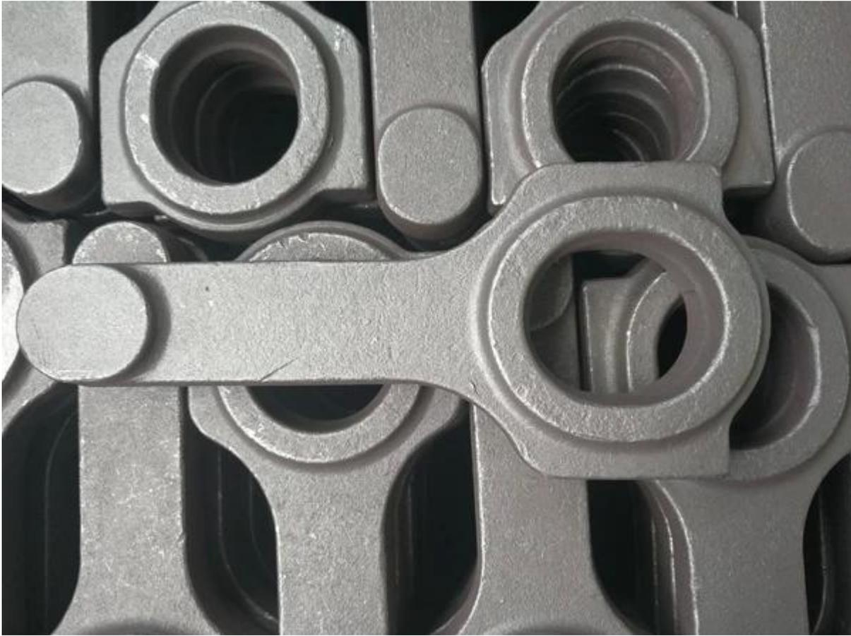
El blanco forjado debe ser apagado y templado con dureza HRC34-38.
