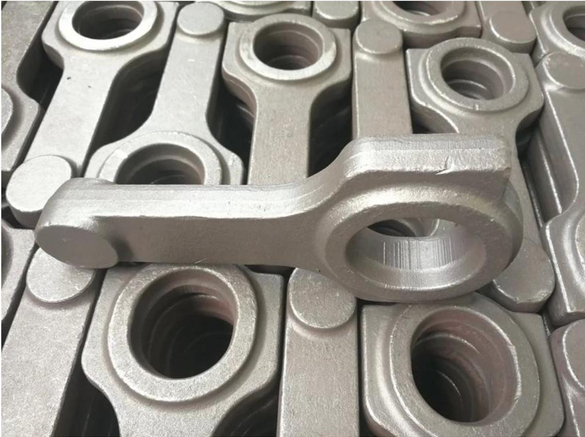
**2. 100% CNC Machine, Tratamiento pulido y granallado.** El artículo que podrías explorar, "[Bielas Hurricane High Performance - Proceso de mecanizado de bielas](#)".
