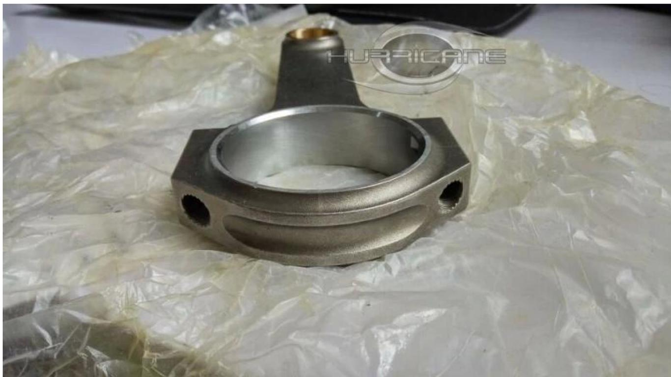
Las bielas de rendimiento refrigerado por aire del huracán se pueden equipar con pernos de varilla arp2000 3/8, PSI 211,829, peso: 38 g por pieza. cuando instale los pernos de la varilla ARP2000 3/8, nuestro par de apriete es 75N \* M, ya que el torque adecuado del perno de la varilla es vital para la vida de la biela. Las bielas refrigeradas por aire forjadas por huracanes también se pueden combinar perfectamente con los pernos de varillas originales "ARP".
