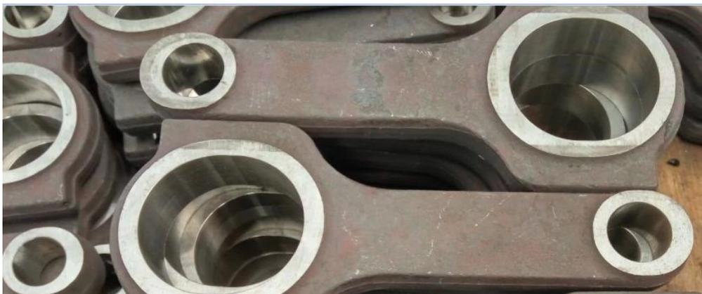
2. Manufacturado como **Forma i-haz** Para proporcionar una mejor combinación de peso ligero y resistencia, cada calor de varilla tratado al HRC 34-38 y luego se disparó para una mayor resistencia a la fatiga, envueltos con 8pcs / set, un equilibrio óptimo para el peso coincido con  $\pm 1$ gramo por juego.
