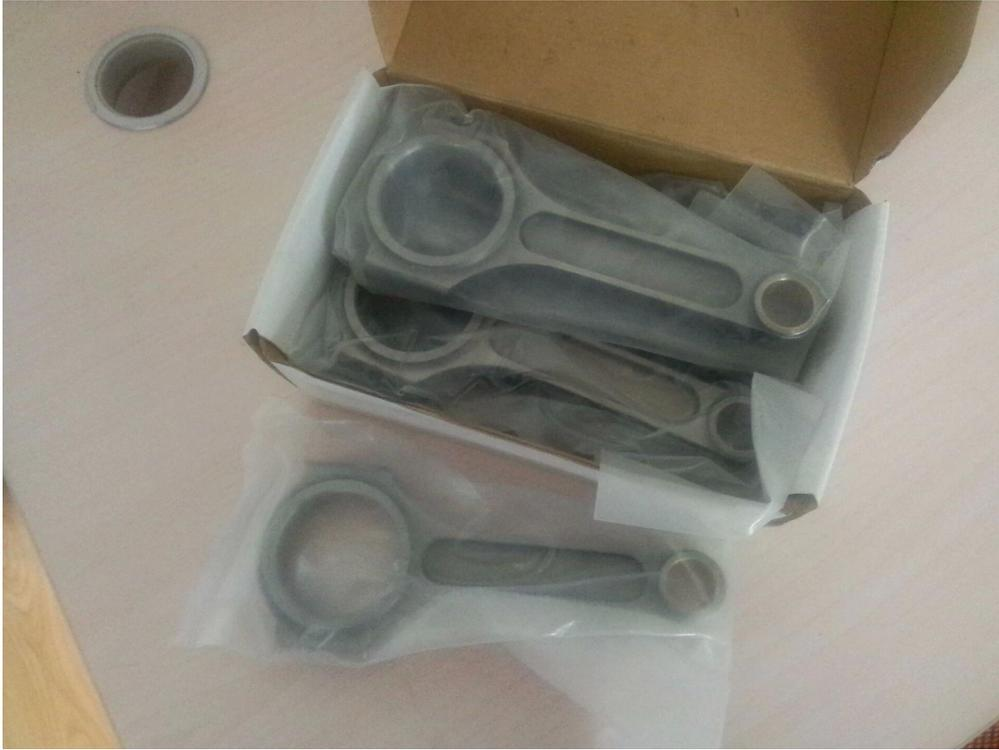
3. Cada varilla tiene un agujero de aceite en la parte superior de la **extremos pequeños**, de modo que el aceite se goteará durante el ciclo de compresión del pistón, se proporcionará lubricación y enfriamiento adicional.
