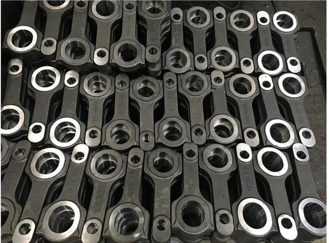
Nota: mazda m3r bielas progreso de mecanizado: taladrar orificios de extremo grande y pequeño.
