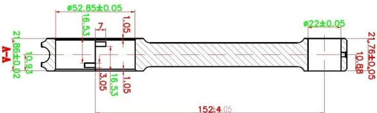
Las bielas Nissan Performance de 6.000 "152.4 mm son directas para todos los motores Nissan / Holden RB30. No requiere ningún tipo de mecanizado. Se adaptan a los motores RB30ET (SOHC), RB30DET (DOHC) y RB30. Aplicaciones: Los orificios de los extremos de los pernos proporcionan lubricación y refrigeración adicionales. El diseño de la viga H puede soportar cargas de compresión más altas. También
