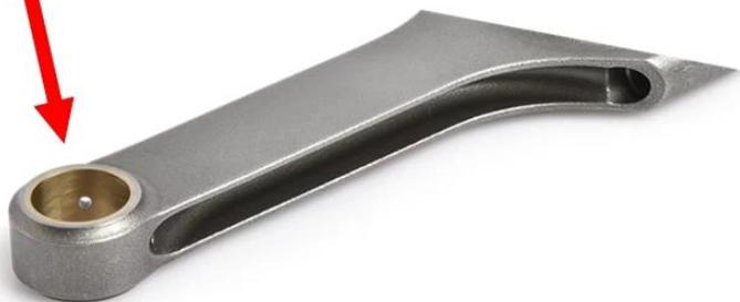
Igual con todas las barras de conexión forjadas 4340 del alto rendimiento en la industria de competición, todas las barras del F20C 100% X-irradiado, Sonic probado, magnafluxed y tiro martillado para la vida mejorada de la fatiga.
