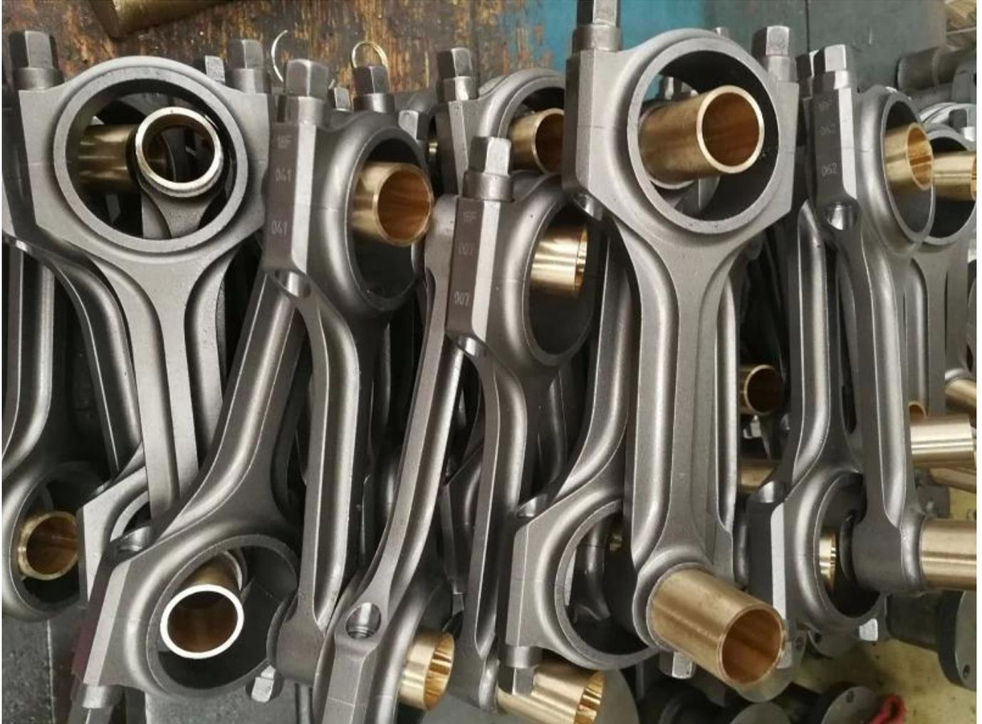
Hurrikan Volvo 850 T5 C70 V70 2.3L 4340 X-Beam-Verbindungsstangen aus geschmiedetem Stahl 139,5 mm sind einbaufertig.
