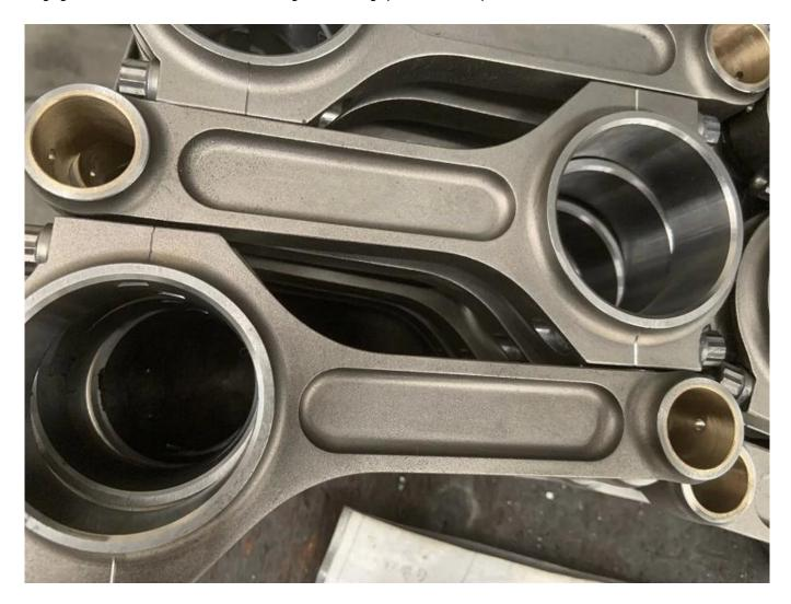
Unser Volvo C70 MK1 2.3L B5234 T3 I5 139.5mm Pleuel ist zum Reinigen und Verpacken bereit.
