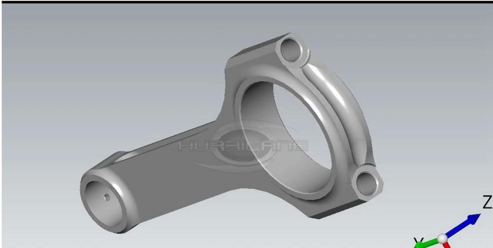
Pro Stab verwendete H-Strahl-Konstruktion, die die Verdrehfestigkeit und die Zuverlässigkeit der Stange erhöht, kann auch etwas Gewicht sparen und die Stangen leichter werden. Mehr, was die Oberseite der kleinen Enden des Stabs mit einem kleinen Ölloch fertig ist, um das Öl während des Kompressionszyklus des Kolbens tropfen zu lassen, und dann zusätzliche Schmierung und Kühlung der Buchse in einem kleinen Ende, was gut sichern kann, um die Stangen mehr zu sichern stärker und langlebig.
