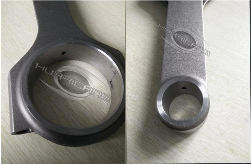
Hurrikan-Fabrik erzeugt H-Strahl, X-Strahl- und I-Strahl Audi VW 144mm 5,670 Zoll geschmiedete Pleuelstangen. Um zu entscheiden, welcher Strahltyp am besten für Ihren Antrag geeignet ist, wenden Sie sich bitte an unseren Vertriebsmitarbeiter.
