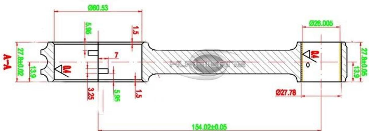
Hurricane geschmiedet 4340 Stahl Pleuelstangen für Toyota 1FZ 1FZFE 154mm Stangenlänge sind perfekt bearbeitet und geschliffen, um die Größe zu verwenden. Die Hurricane-I-Beam-Pleuelstange wurde für Anwendungen entwickelt, bei denen die Stabfestigkeit die Nummer 1 ist, die über 1000 + HP pro Satz liegt.
