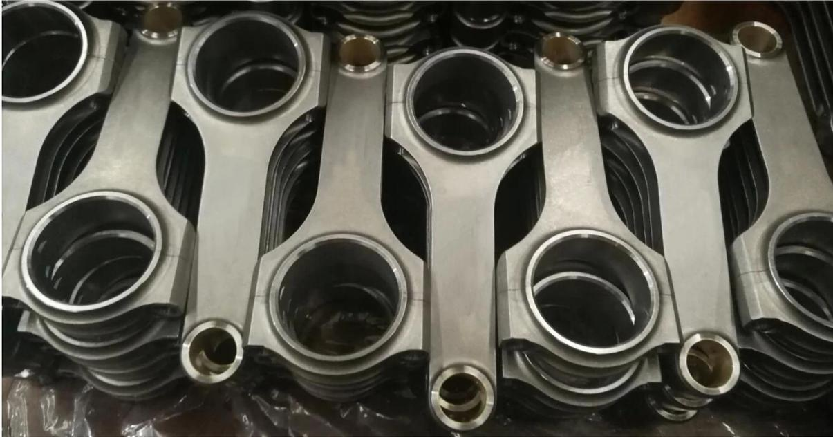
Hinweis: Die Toyota 2.2L 5SFE Pleuelstange ist zum Wiegen und Verpacken der Waage bereit.
