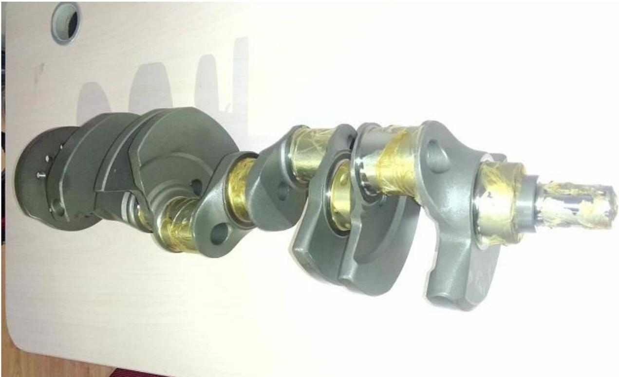
Die Chevy 350 kleinen geschmiedeten Kurbelarme und -konturen wurden bearbeitet und kugelgestrahlt, wodurch die Intensität effektiv erhöht wird
