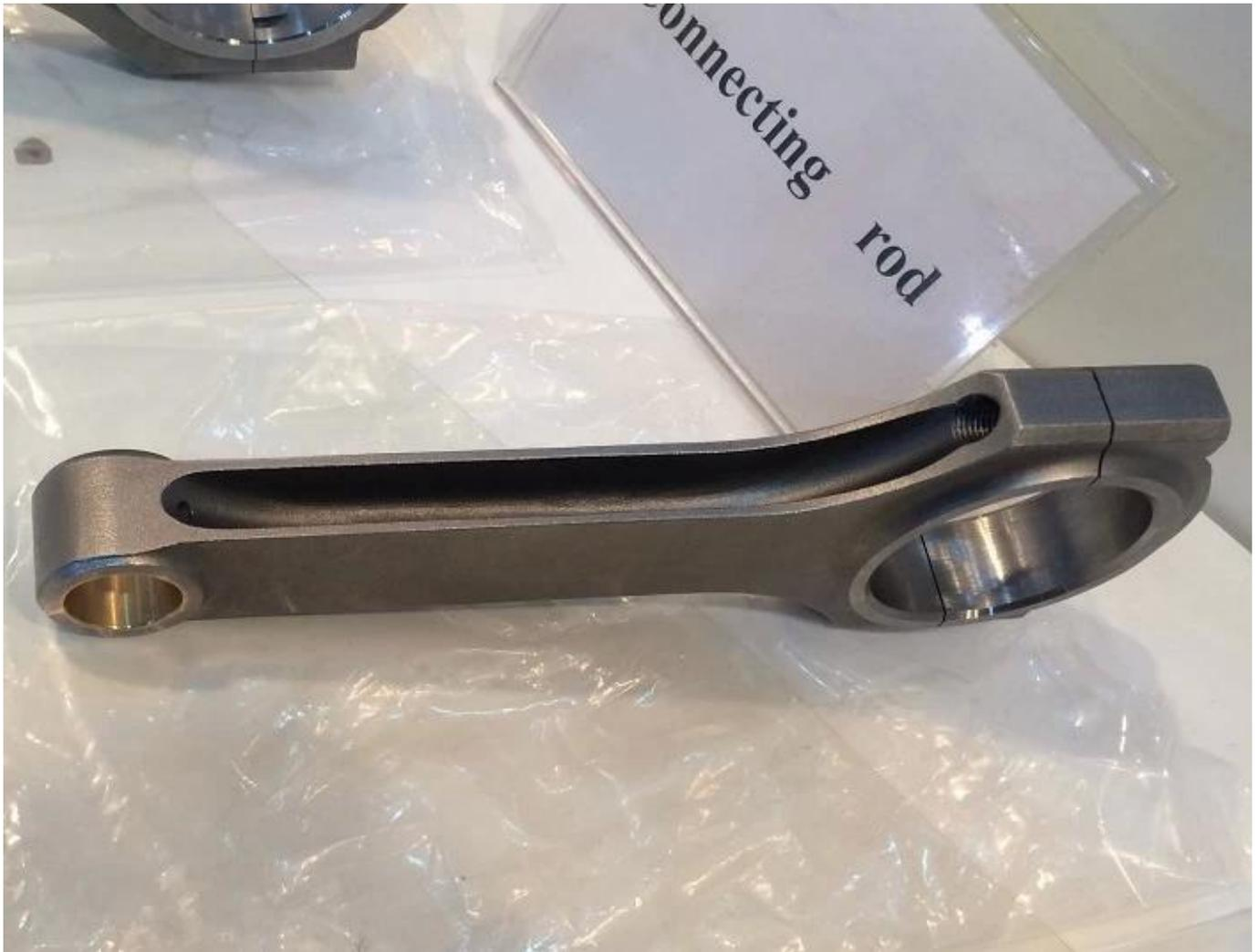
Diese 6,350-Zoll-Buick V6-Pleuelstangen sind wärmebehandelt und für zusätzliche Festigkeit kugelgestrahlt. Diejenigen, die eine lange Rute für den 3.8L- oder 4.1L-Motor in Betracht ziehen, werden sicherlich die Handwerkskunst schätzen, die in diese h-Balken aus Stahl eingesetzt wird. Sie passen perfekt zu Ihren 1986er oder 1987er Buick Grand National-, T-Type-, Turbo T- oder GNX-3,8-Liter-Turbo-V6-Motoren.
