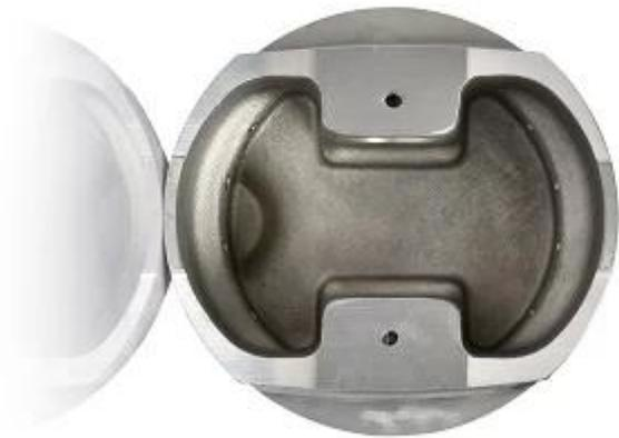
Diese BMW 92mm Kolbenoberseite ist entworfen, um flach zu sein, um eine höhere CR zu erreichen.
