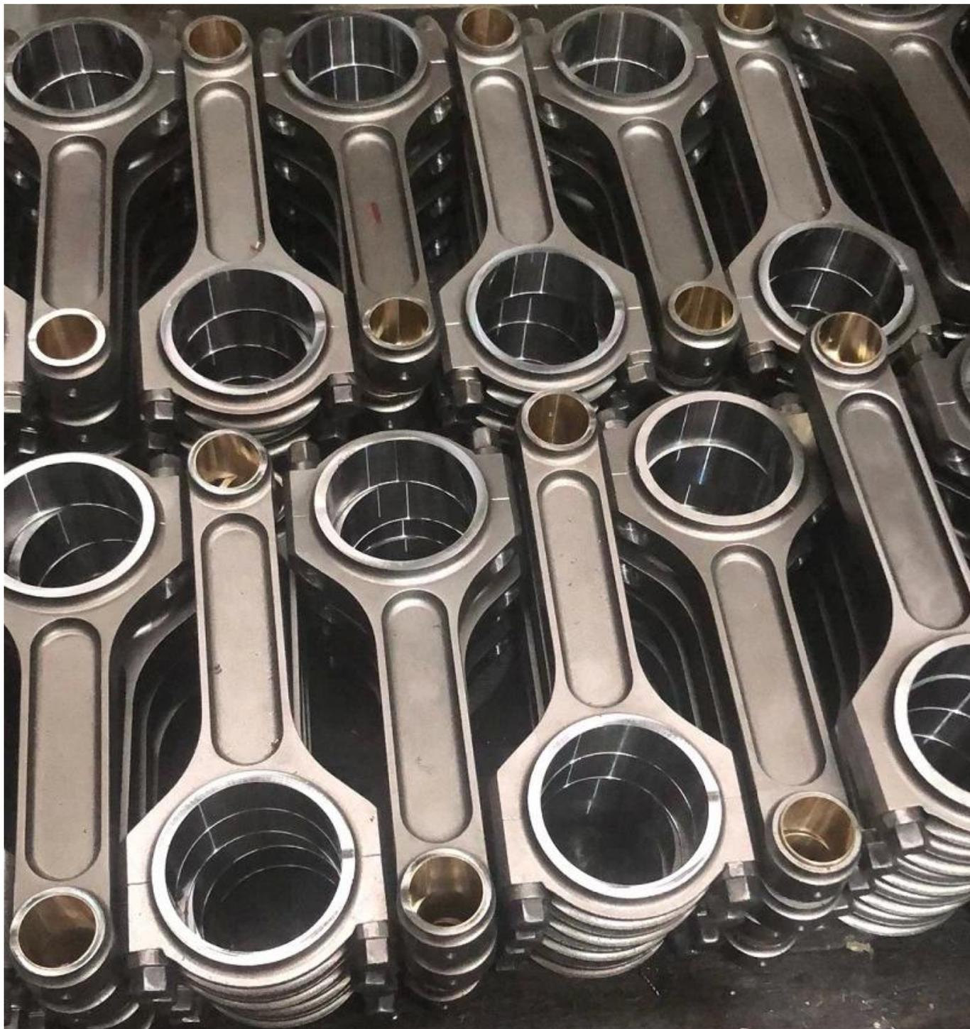
Hinweis: Die Pleuelstangen des Typs Hurricane I dodge srt-4 können jetzt geschliffen werden. Jedes Stück der SRT-4-Pleuelstangen für hohe Beanspruchung wird mit der Sonnen Honmaschine auf die richtige Größe geschliffen.
