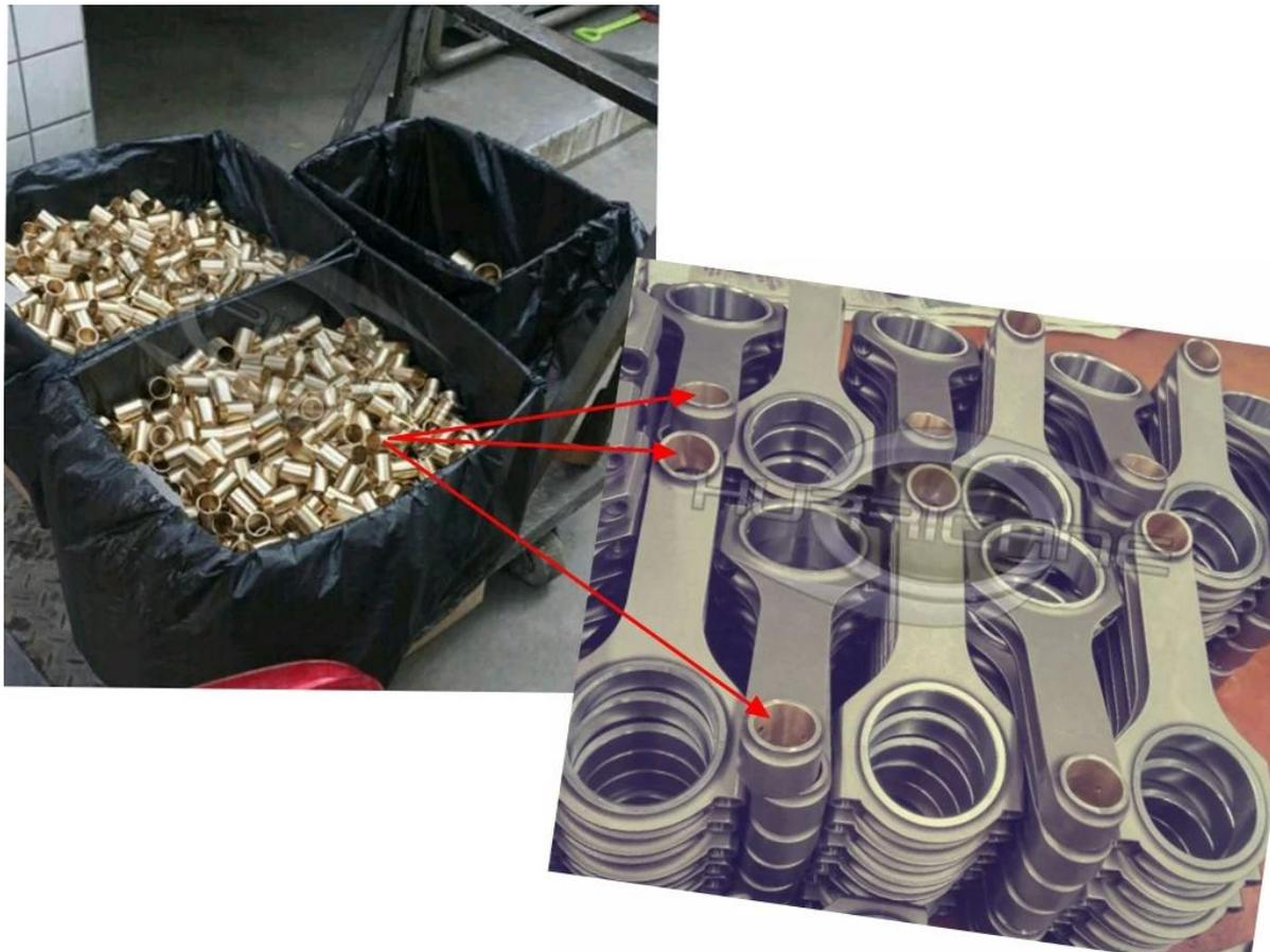
Doppelöllöcher, die in das kleine Ende der Stange gebohrt wurden, um das kleine Ende positive Schmierung zu ermöglichen.
