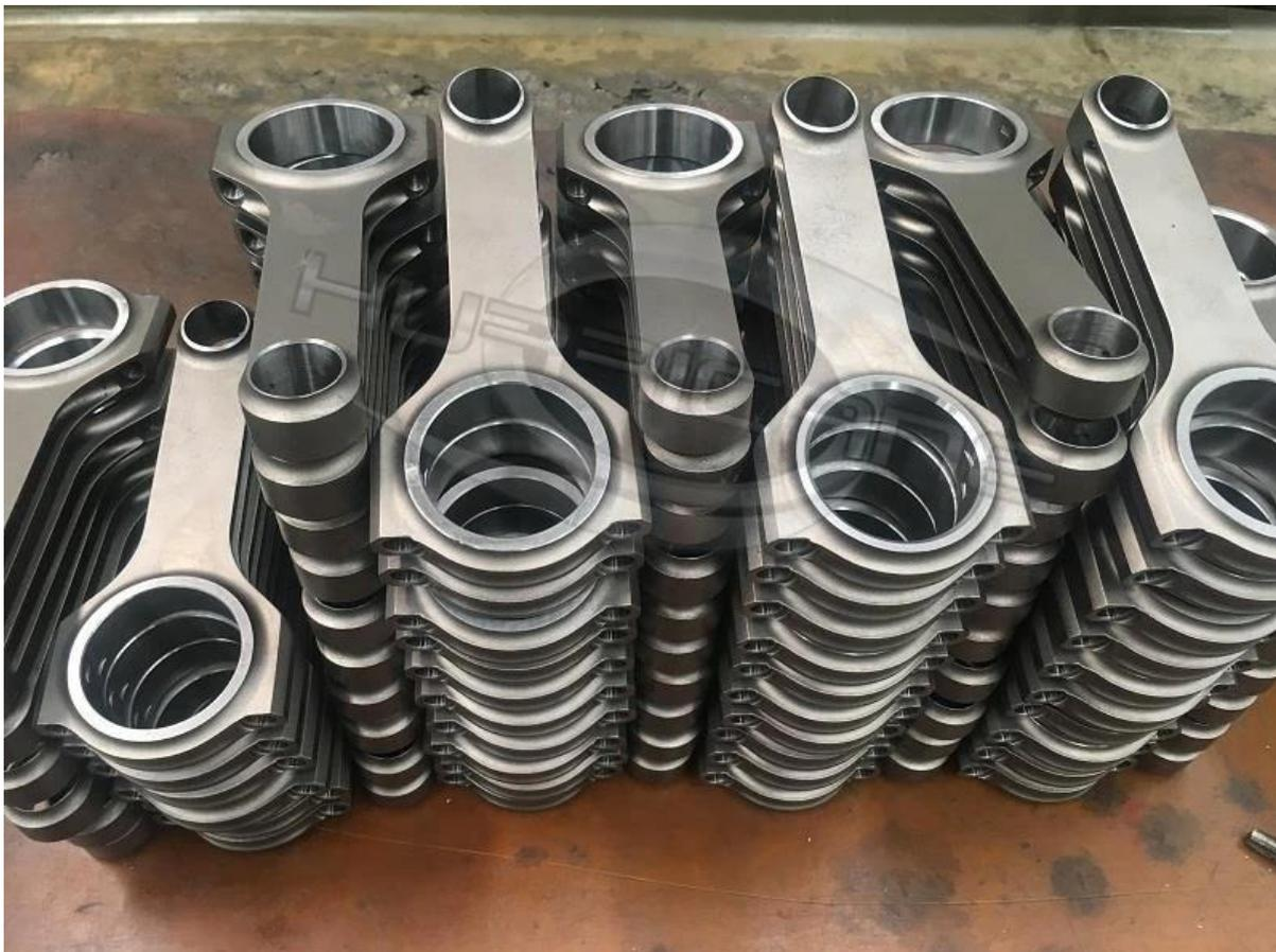
Alle kleinen Ziele installierten hochwertige Bronzebuchsen, um Verschleißfestigkeit für schwebende Kolben bereitzustellen.
