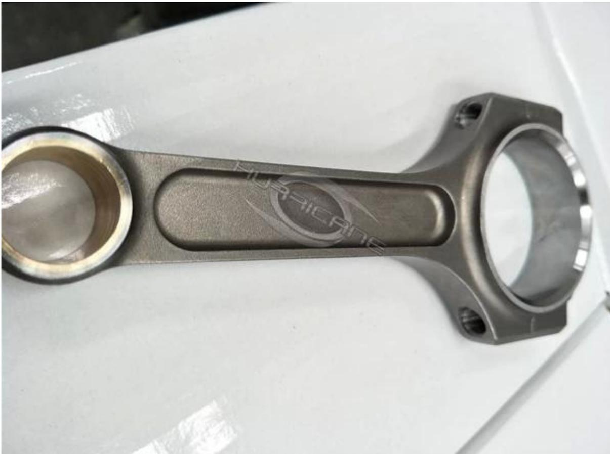
4). Magnaflux geprüft und maßlich geprüft.
