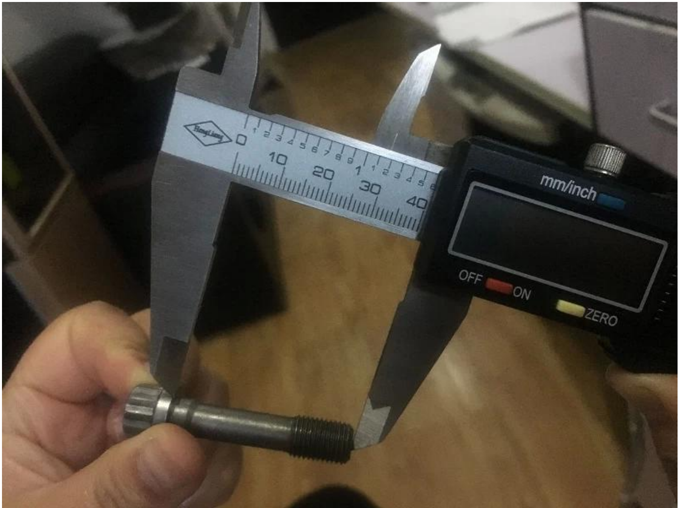
Leistungsersatzschrauben für Pleuelstangen aus Hurricane 4340-Stahl
