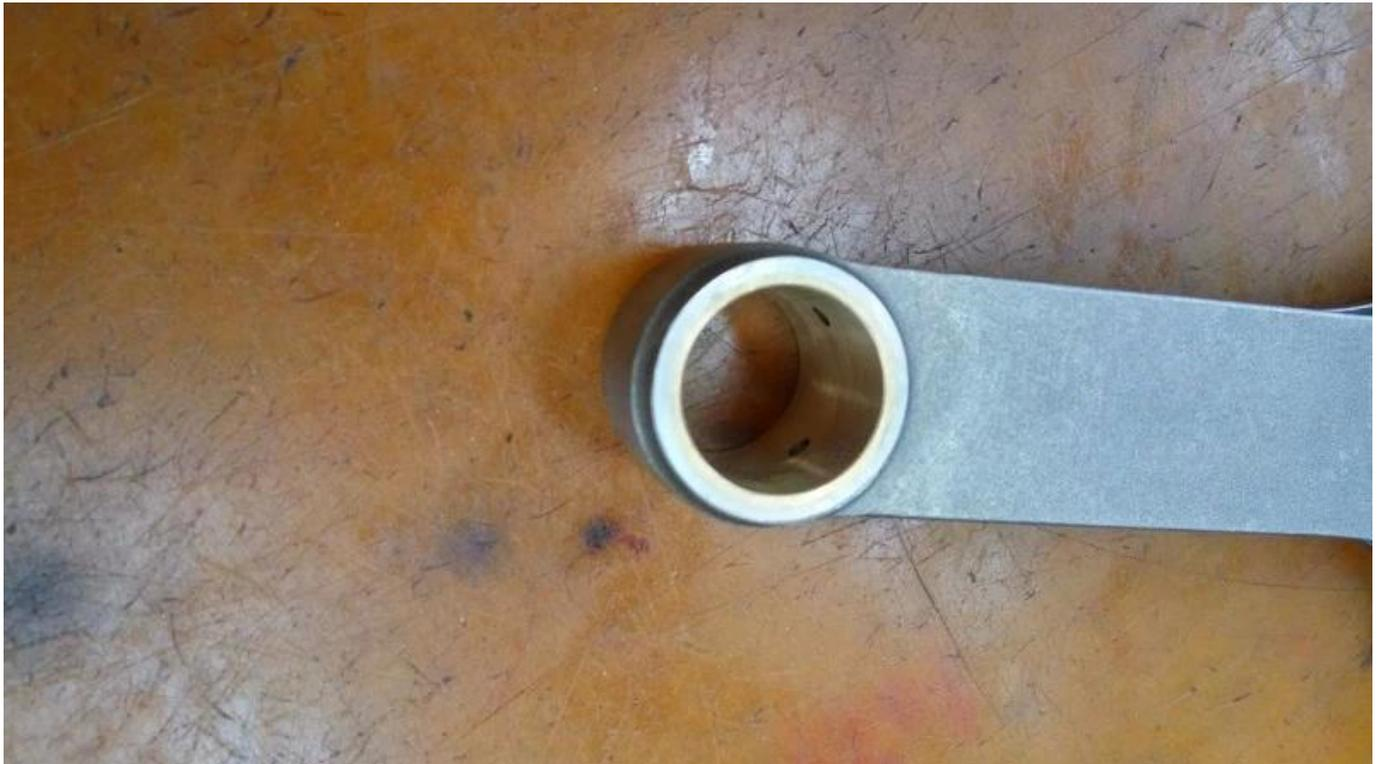
Hinweis: Toyota 2jzgte h Balkenverbindungsstangen Ölbohrung am Stiftende für Schmierung.
