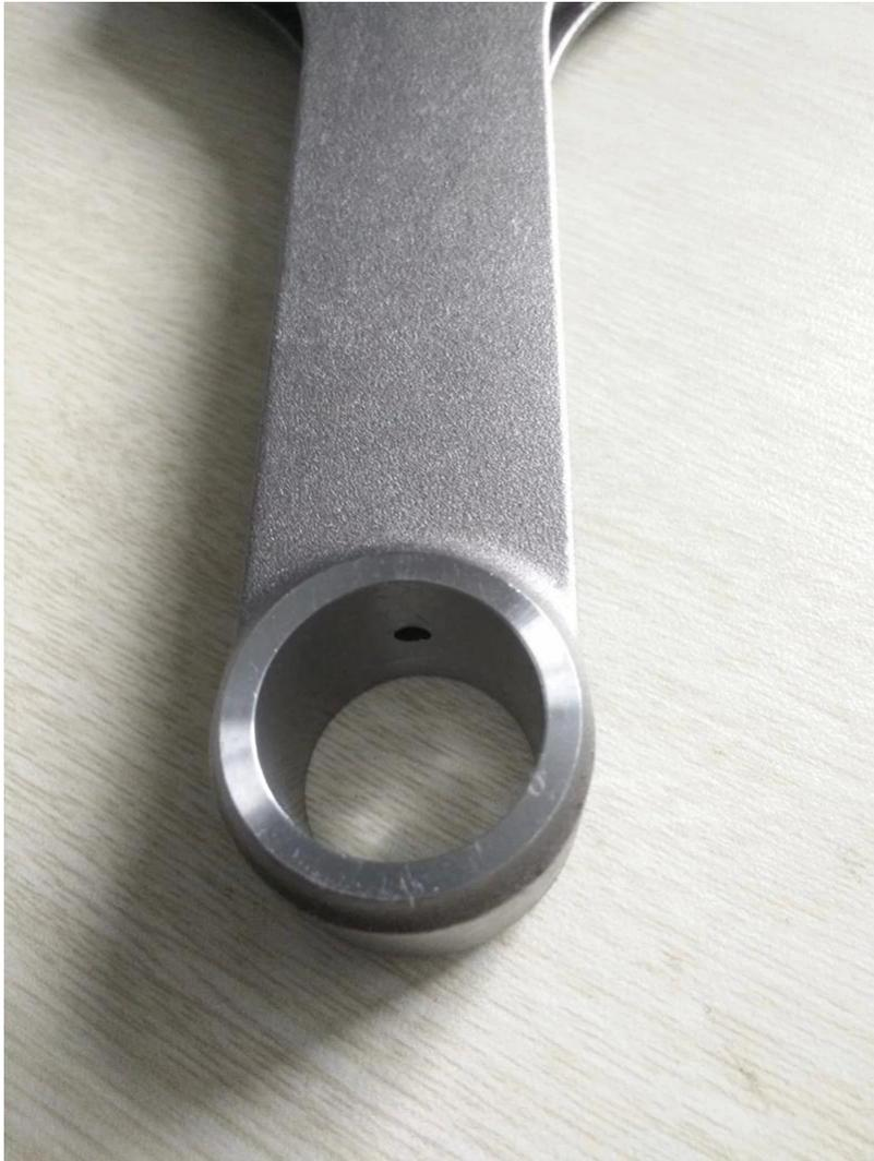
Das Bolzen-Loch und Gewinde werden durch CNC und präzise Schneiden-Werkzeug gebildet. Sie finden kein Werkzeug Spuren auch auf der Schraube Loch Oberfläche. Hurricane Connecting Stangen Ford 460 verwenden ARP2000 7/16 Bolzen. nehmen Sie unsere 3/8 Rod Bolts als Referenz, könnte psi erreichen 211.829. Wir liefern nicht Original-ARP-Blitze, aber wenn Sie uns Original-ARP-Schrauben an uns, können wir auf die Verbindung von Stangen vor dem Verpacken angebracht zu helfen.
