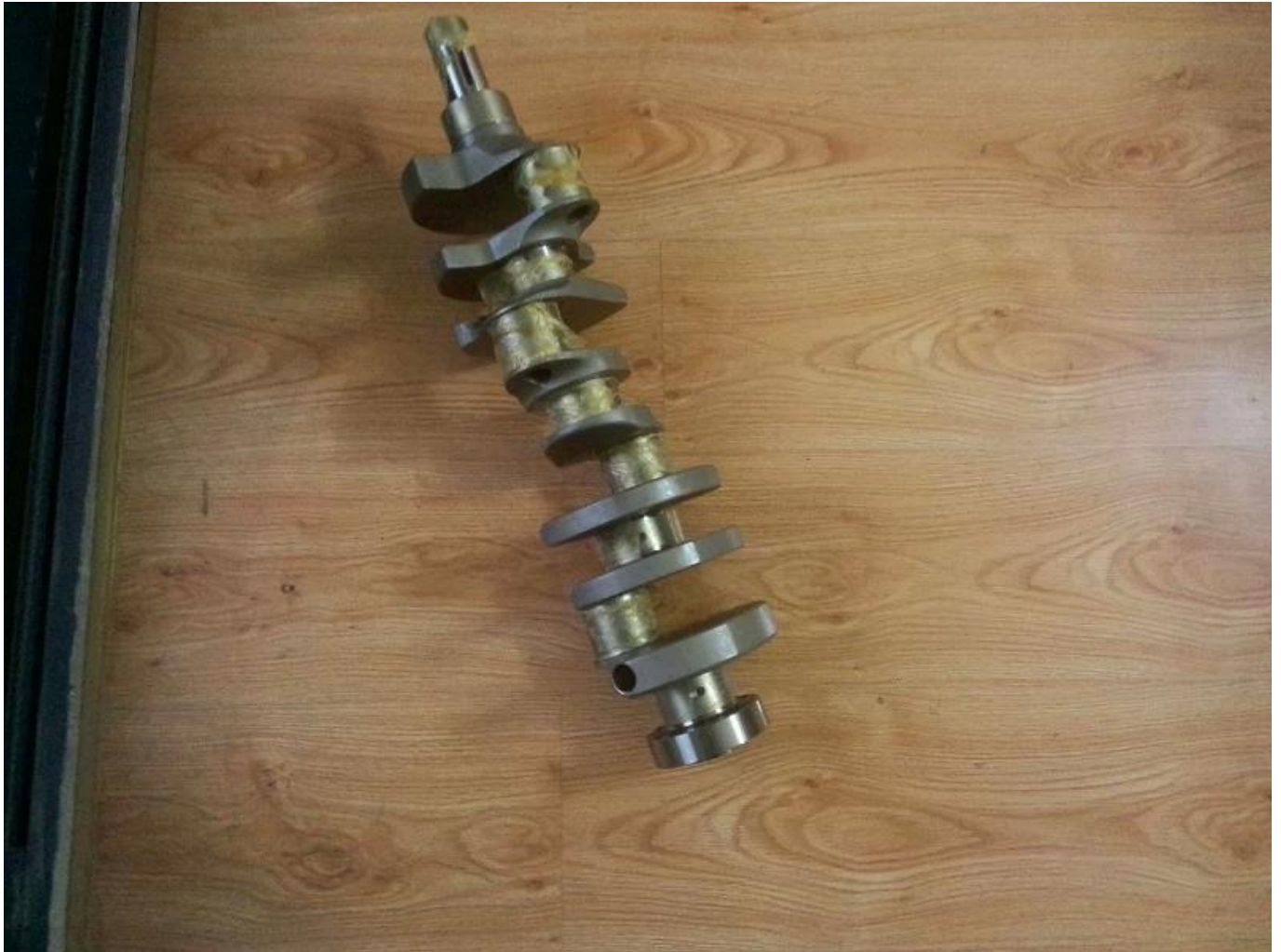
Hurricane Ford Kleinblock 302 3.250 "Kurbeln sind Magna Fluxed, Shot Peened und alle Zeitschriften sind Nitrided, Precision Ground und Micro poliert. Diese Fortschritte werden Stärke und Journal Härte.
