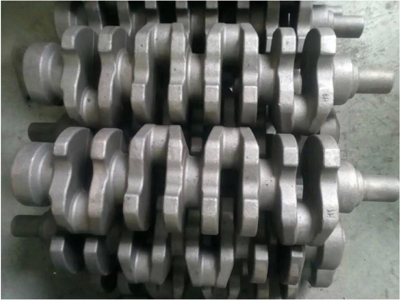
Überholte Kurbelwelle für Ford 302 Schmiedestücke: Multiple Matrize geschmiedet aus 4340 Chromoly (eines der stärksten Materialien für Kurbelwellen)
