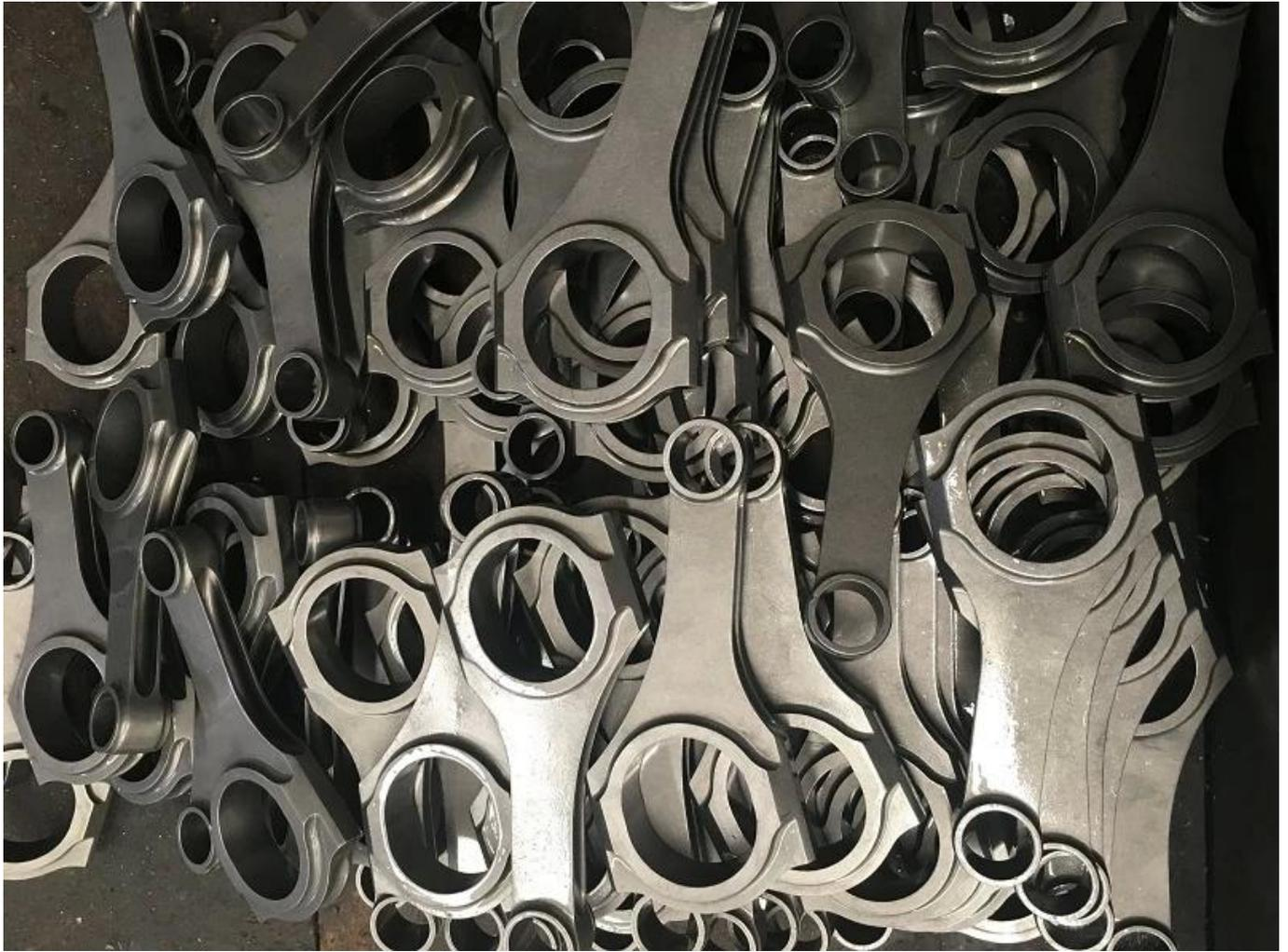
Präsentation einer neuen Pro H-Profil Pleuelstange für den Subaru BRZ / Scion FR-S FA 20 Motor. Micro Polishing verbessert die Haltbarkeit der Stäbe und hinterlässt ein gut aussehendes Finish. Shot Peening an der Oberfläche der Pleuelstangen kann Stress abbauen und die Ermüdungsfestigkeit verbessern. Weitere Informationen finden Sie auf unserer Nachrichtenseite: [Pleuel Shot Peening und Mirco-Polishing, spezielle A-Level-Optik](#)
