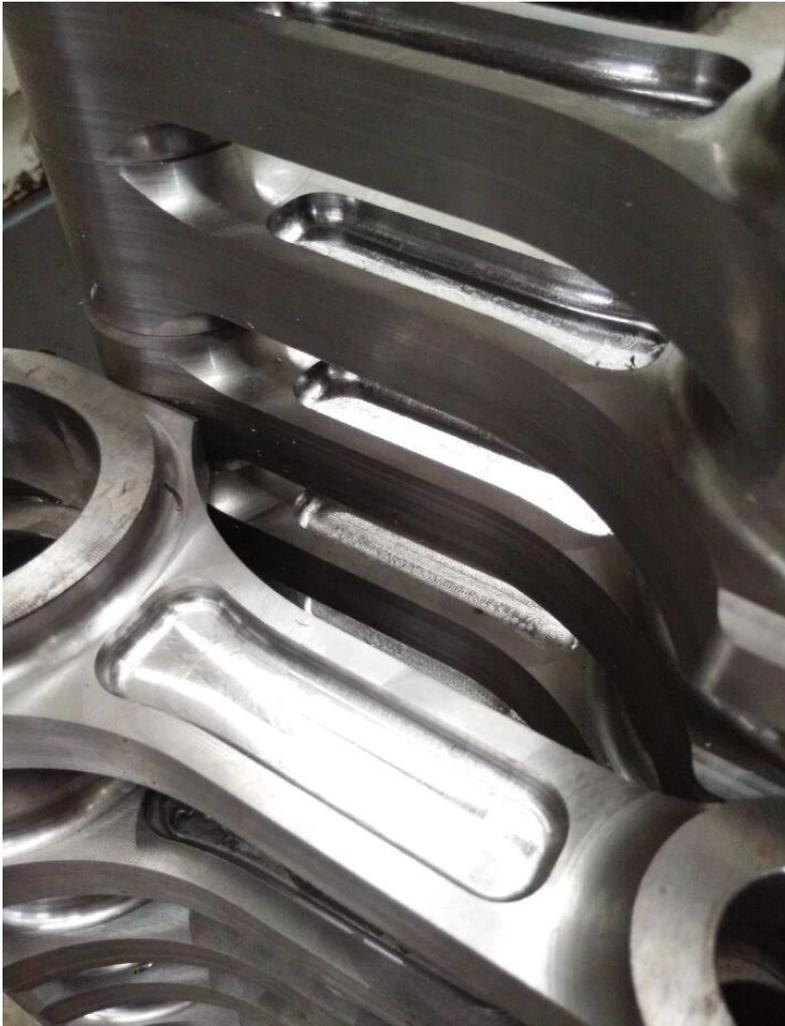
Die stark verjüngte I-Trägerkonfiguration der Duramax-Dieselerverbindungsstangen kann extreme Motorlasten bewältigen. Der sich verjüngende Balken ermöglicht eine gewisse Gewichtsersparnis am Hubkolbenende und bietet mehr Spielraum für Kolben mit Vollverpackung.
