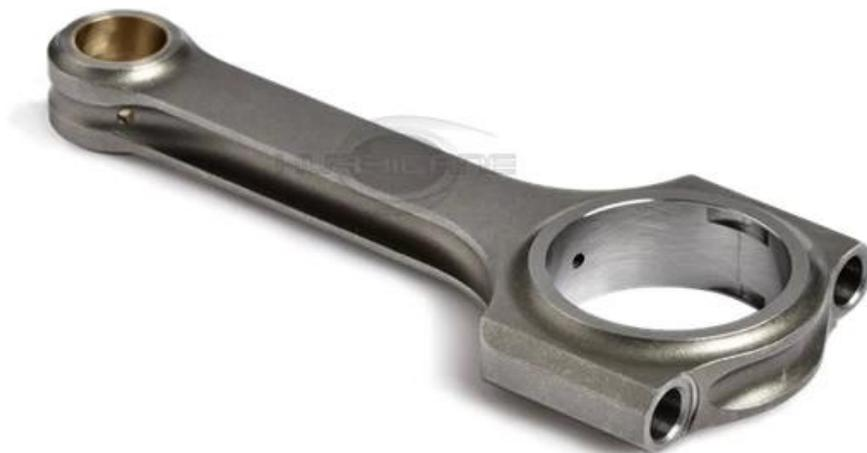
Hurricane Pleuel für Honda B16 sind buriert und poliert, diese Prozesse entfernen Grate und machen die Oberfläche glatt. auch gestrahlt, bedeutet dieser Vorgang kleine Balltrefferfläche und macht sie an der Oberfläche, erhöht die Stangenstärke. Wir verwenden auch Sunnen Honing Machine, um geschmiedete
